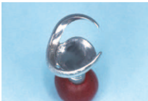
図9 完全自動研磨にはバレル研磨と乾式電解研磨の組合せが適しており、非常にスムーズな表面形状が得られる。
