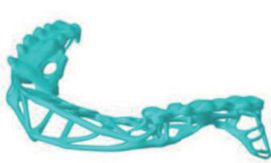
図11 トポロジー最適化により軽量化したフレームワーク
