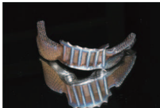
図10 フレームワークの形状を変えることなく中身を粗にして軽量化が図れるポーラスラティス構造
