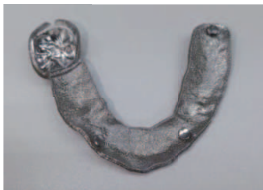
図6 積層造形とミリングを一体化させたハイブリッド加工は、良好なクラスプの適合を得ることができる。
