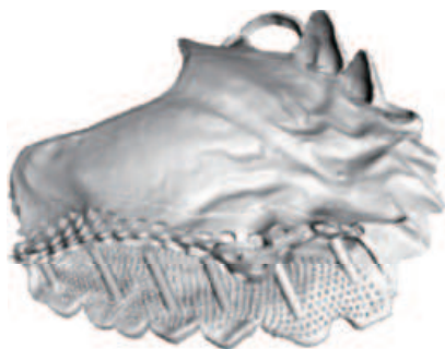
図8 金属積層造形は立体的フレームワークや複雑な構造にこそ有効であり，金属構造義歯が日常臨床に広く普及していくものと期待される。
