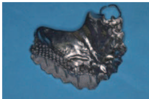
図8 金属積層造形は立体的フレームワークや複雑な構造にこそ有効であり，金属構造義歯が日常臨床に広く普及していくものと期待される。
