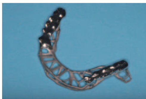
図11 トポロジー最適化により軽量化したフレームワーク
